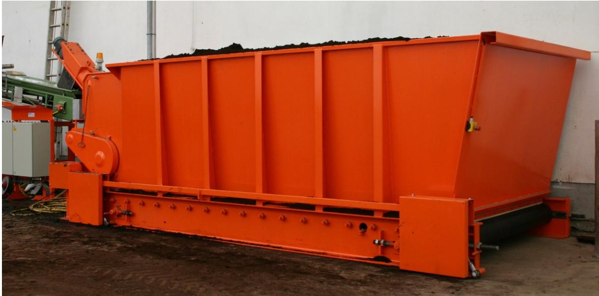
**Torfaufbereitungssystem mit großem Erdspeicher für Befüllung mit Radlader oder Grabgeräten.**
