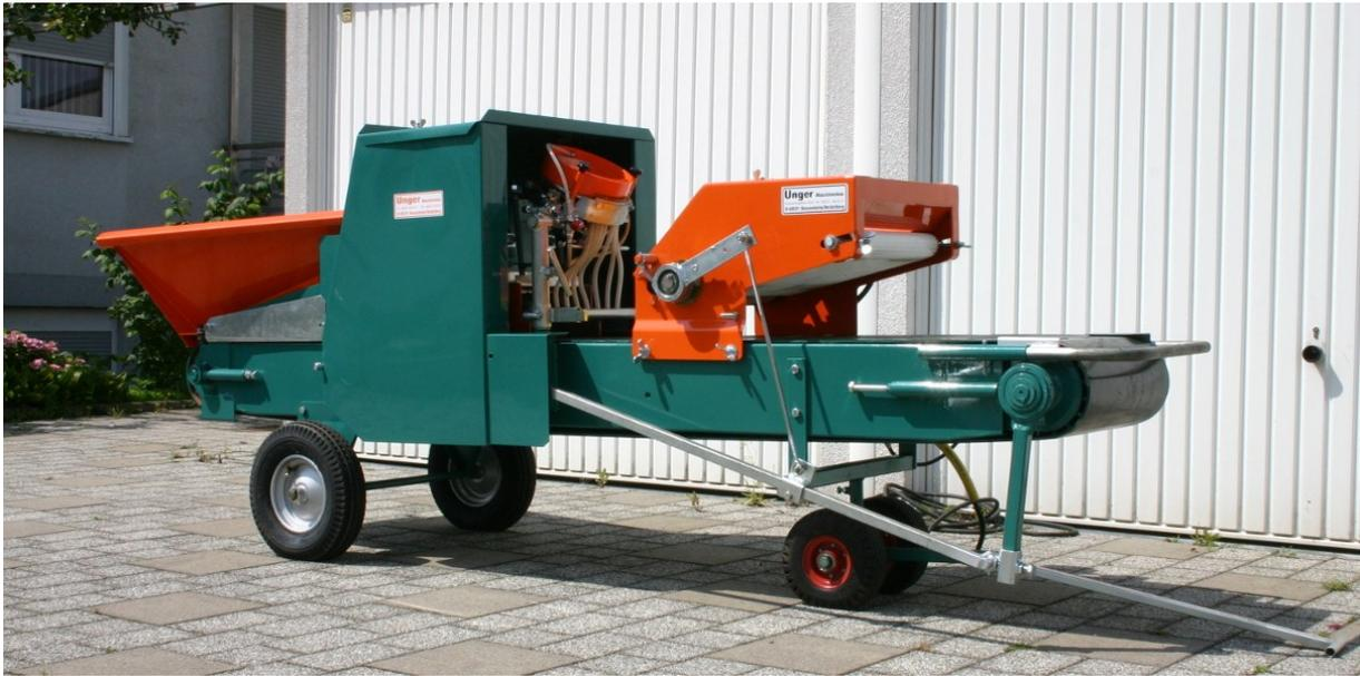
**Die Erdtopfmaschine für kleinere Produktionsleistungen mit Arbeitsbreite 30 cm.**
